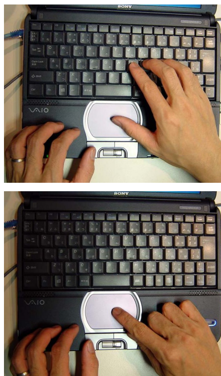
図1. タッチパッド操作時の指の位置：ホームポジションから手を離さないで操作できない
